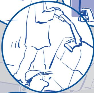
Elektrischer Hubwagen: Lasten an Schrägen bergseitig führen
