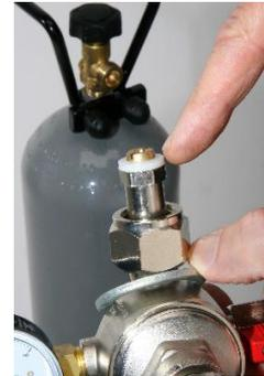
Abb. 3: Dichtung am Druckminderer
