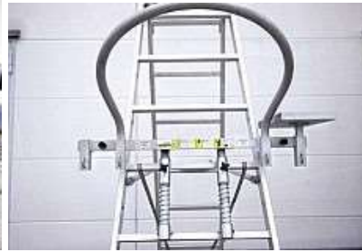
Bild 9, links: Podestleiter mit Absturzsicherung Bild 10, Mitte: teleskopierbare Podestleiter Bild 11, rechts: einhängbarer Bügel zum Schutz gegen Absturz
