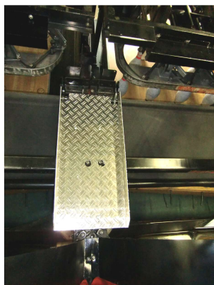
Abb. 9: ausreichend breiter und rutschfester Podest
