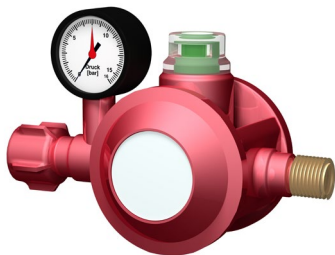
Abb. 6 Druckregleinrichtung S2SR mit TAE, Manometer und Sichtanzeige
