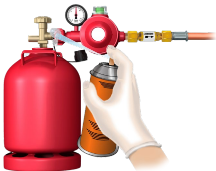
Abb. 10 Dichtheitskontrolle mittels Lecksuchspray nach Anschluss der Druckregleinrichtung an die Flüssiggasflasche
