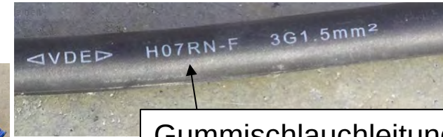
Gummischlauchleitung • Mittlere mechan. Beständigkeit • UV-resistent • Kältebeständig
