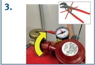
Jetzt mit der Hand Druckregeleinrichtung abschrauben – rechtsherum drehen, keine Zange benutzen
