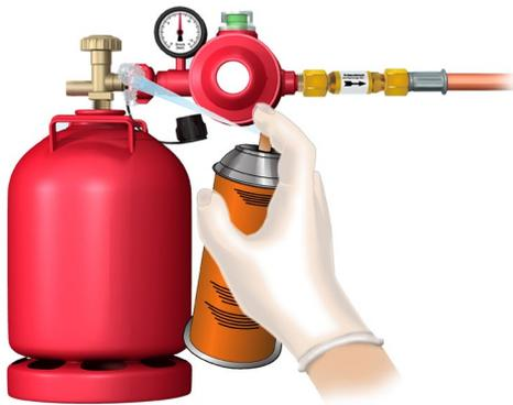
Abbildung 7: Dichtheitskontrolle unter Druck mittels Lecksuchspray
