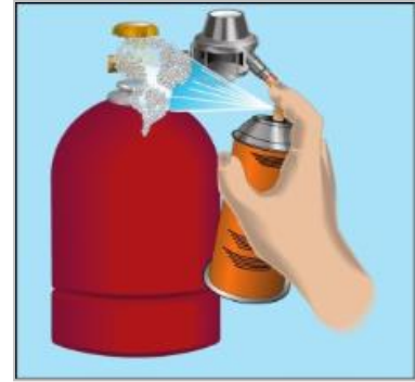
Bild 5 Dichtheitsprüfung der Anschlussverbindung
