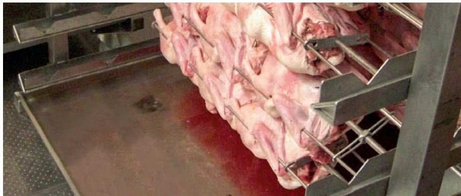
Abbildung 19: Zum Grillen vorbereitetes Geflügel wird auf Drehspießen im Kühlraum zwischengelagert, zur Aufnahme des Fleischsaftes dient die abnehmbare Bodenwanne mit verschließbarem Ablauf.
