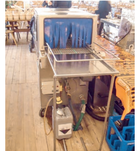
Abbildung 9: Gläserspülbereich in einem Festzelt. Eine Spülmaschine mit automatischer Reinigungsmitteldosierung ist zu empfehlen.
