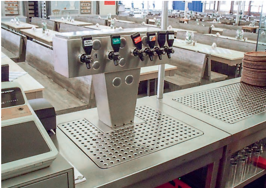
Abbildung 25: Schankanlage für alkoholfreie Getränke mit Tropfmulde
