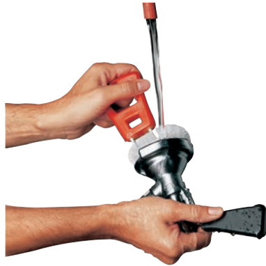
Abbildung 27: Reinigung einer Zapfarmatur
