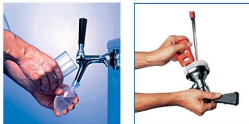
Bewährt hat sich ein chemisch-mechanisches Reinigungsverfahren. Die Reinigung und Desinfektion ist von demjenigen zu bescheinigen, der die Reinigung durchgeführt hat (z. B. Betreiber oder Fachfirma). Die Dokumentation der Reinigung und Desinfektion ist an der Betriebsstätte zu hinterlegen.
