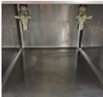
Abb. 7 und 8 Fritteuse mit verdeckter Anbringung der Fettablassvorrichtung
