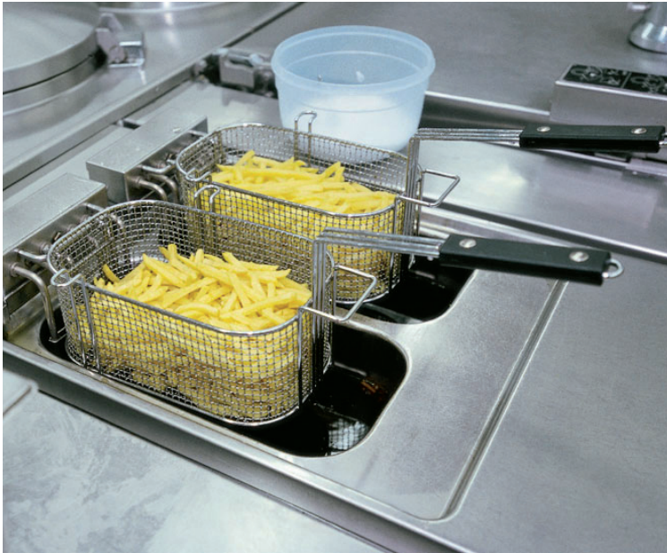
Abb. 4: Fritteuse mit sicher eingehängten Körben
