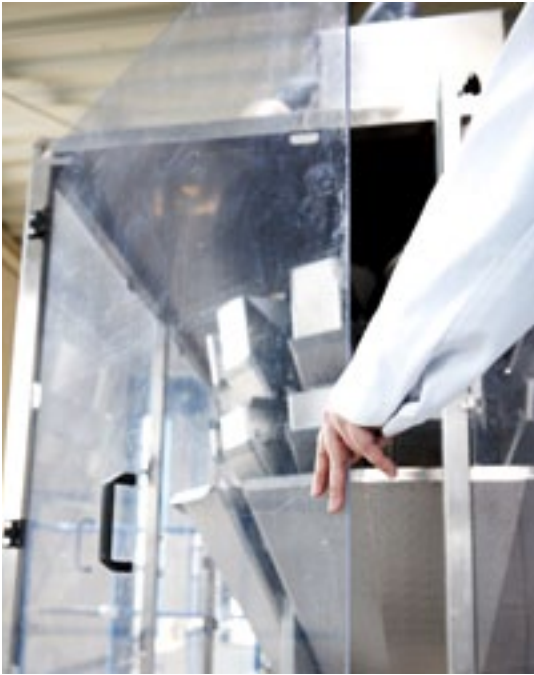
Bild 4 Verpackungslinie 2: Die Scheiben der Einhausung lassen sich jetzt einfach öffnen, und sie schließen von alleine wieder. Erzielte Pegelmin- derung am Bedientableau von 4 dB(A) und am Drehtisch von 2 dB(A)
