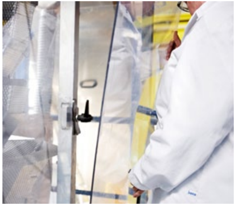
Bild 5 Verpackungslinie 2 vorher: Die Scheiben mussten zum Öffnen aus der Verankerung gehoben und anschließend wieder eingesetzt werden.
