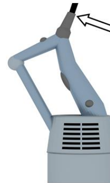
Austrittspunkt des Spannungsversorgungskabel an der Maschine (kann bei starker Beanspruchung beschädigt werden)
